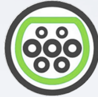
Ausgang: AC TYP2 3 Phasen Ladeleistung bis zu 22 kWh
