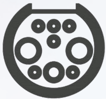
Ausgang: DC GB/T Ladeleistung bis zu 160 kWh
